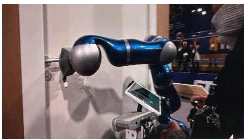
Mit einem "verlängerten" Arm wird die Türe vom Rollstuhl aus zuerst geöffnet und danach wieder geschlossen.
